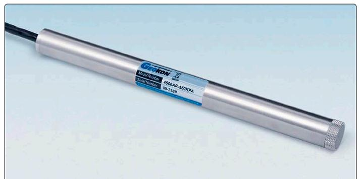
• Model 4500AR "Autoresonant" Piezometer.
