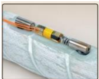
Deformímetro Modelo 4151 montado sobre barras de refuerzo de fibra de vidrio
