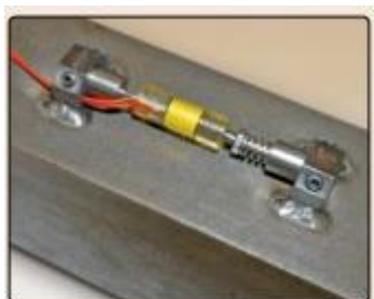
Modelo 4150 con soldadura de arco opcional en bloques de montaje
